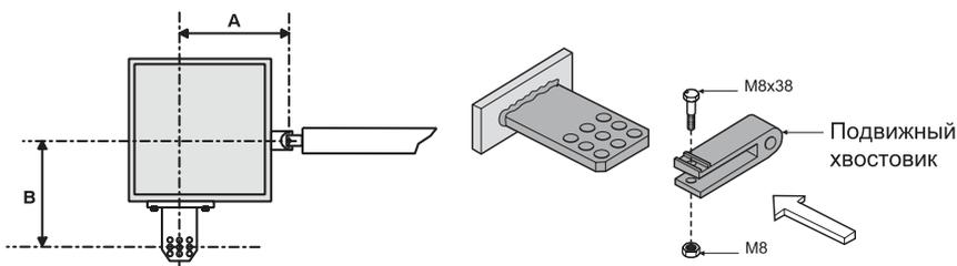
1) Закрепите задний кронштейн с соответствующей крепежной пластиной на столбе, как показано на рисунке выше, соблюдая размеры А и В, а именно расстояние между осями центрального отверстия кронштейна и стержня петли ворот. Задний кронштейн имеет несколько отверстий, которые облегчают установку привода, а также дают возможность изменять угол открывания ворот. В зависимости от положения петель ворот можно удлинить или укоротить задний кронштейн.
