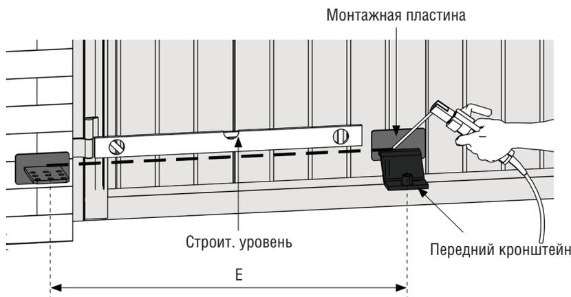
3) При закрытых воротах установите монтажную пластину на створку ворот. Убедитесь, что передний кронштейн установлен горизонтально на одном уровне с задним и выдержан размер D.
