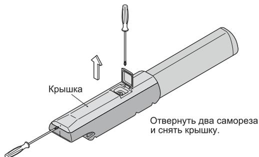
1. Отверните два самореза и снимите крышку
